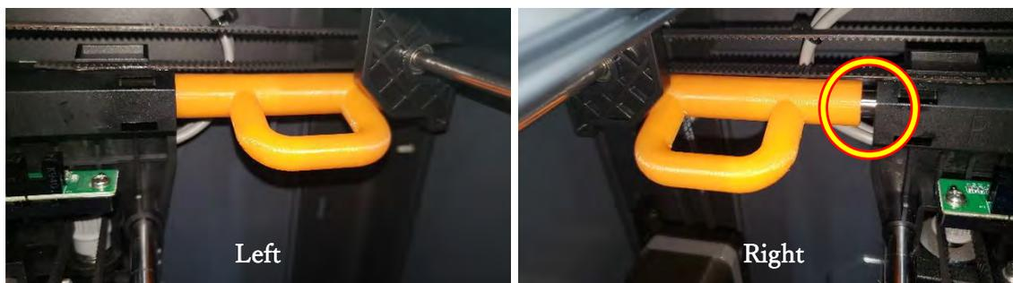
5. 隙間が無い側(今回は左側)の Y 軸ガイドロッドに「XY\_calibration\_tool\_2」を付ける。
