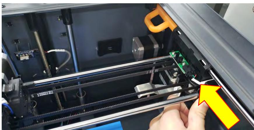
7. 「XY\_calibration\_tool\_2」を外し、左右の隙間が無くなったら調整完了。
