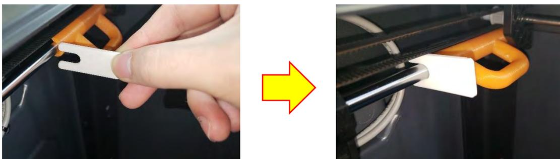
6. 「XY\_calibration\_tool\_2」を挟んでいない側のプラスチックブラケット持ち、奥に強く押し付ける。調整が終わるとベルトが移動する音が鳴り、隙間が無くなる。
