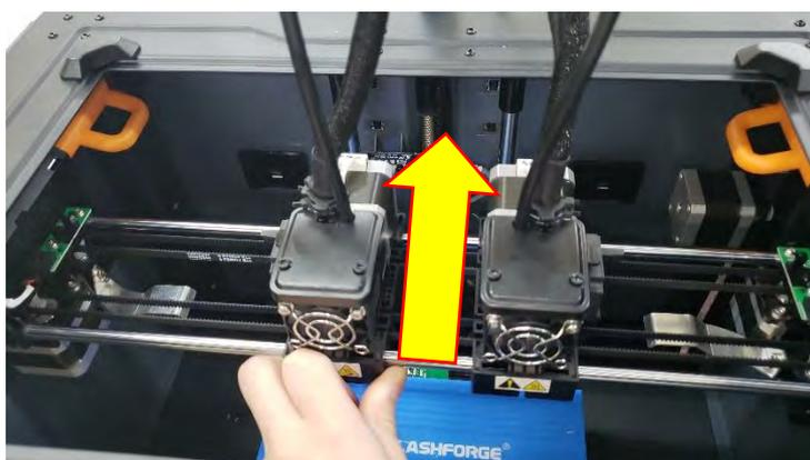
4. 「XY calibration tool」とプラスチックブラケットの間に隙間が無いか確認する。
